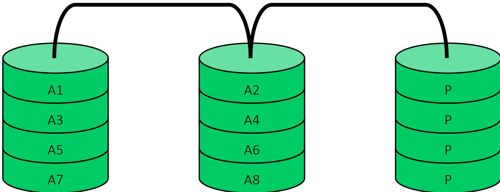
Striping mit einem Striping-Faktor von einigen wenigen Bytes. Zu jedem dieser Gruppen von Bytes wird auf einer **Paritätsplatte** das Paritätsbit gespeichert.
