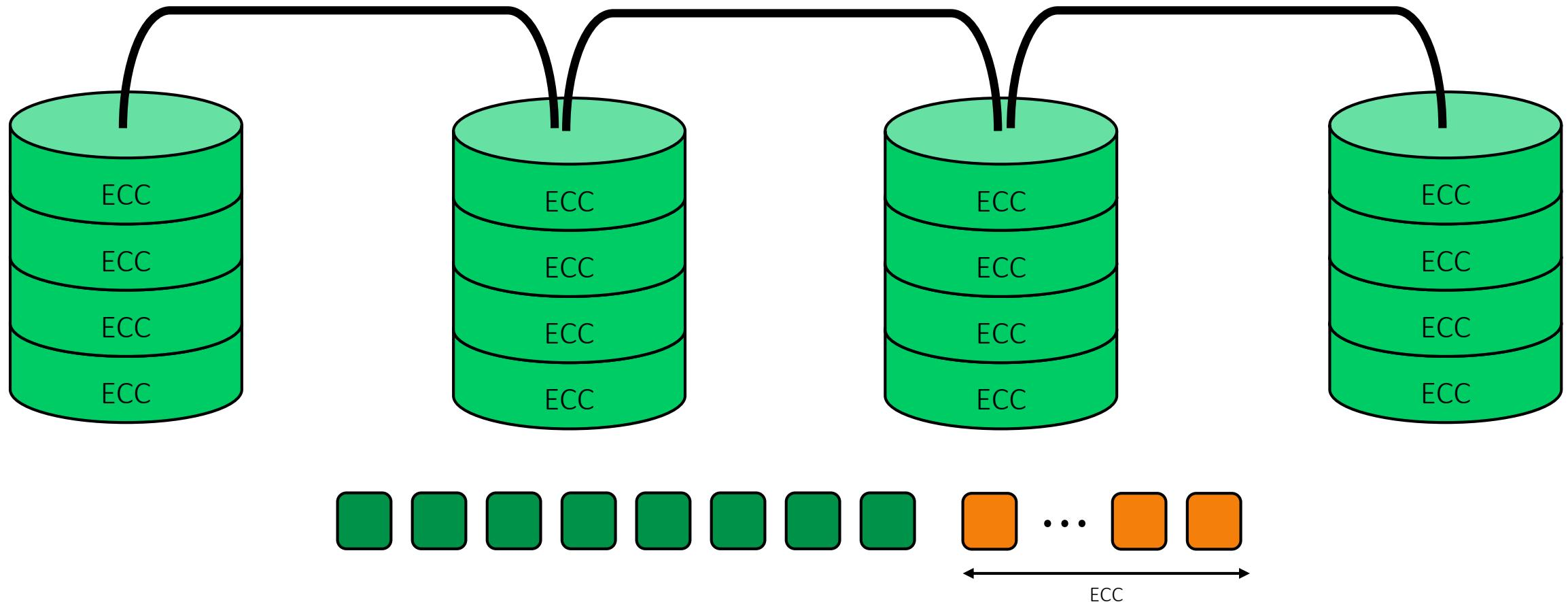
Jedes Byte wird im Sinne eines fehlerkorrigierendem Codes gespeichert. Zusätzlich Striping mit Striping-Parameter von einem Bit. Für dieses Verfahren ist sehr spezielle Hardware nötig.
