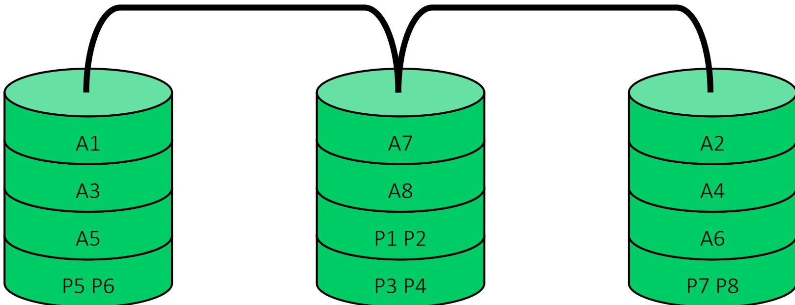
Wie RAID 4 aber mit Striping der Parität und Verteilung auf alle Platten um die Paritätsplatte zu entlasten.
