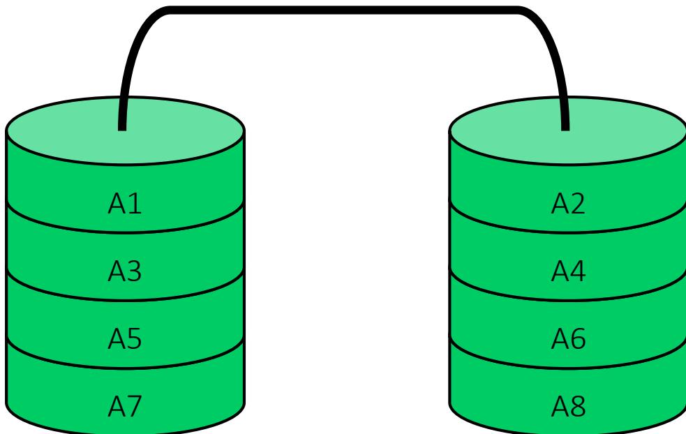
Daten werden zerlegt und auf (mindestens zwei) kleinere Festplatten verteilt. Diese werden zu einem logischen Laufwerk zusammengeschaltet. Es bestehen bei dieser Variante keine Redundanzen.
